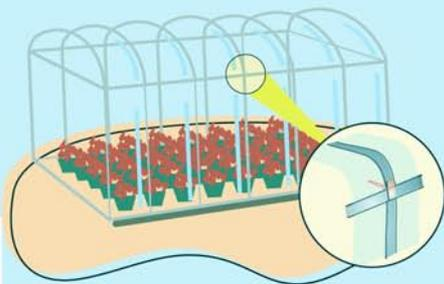
В местах прохождения кромки через дугу добавьте подкладной элемент (щепку, кусочек пластмассы). Обхватите дугу, подкладку и пленку проволокой, проколов в соединительной полосе отверстия, и завяжите проволоку изнутри теплицы.
